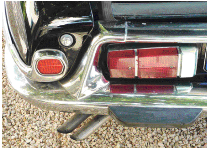
Mit nur einer Schraube lassen sich die hinteren Kotflügel für den Reifenwechsel entfernen.
