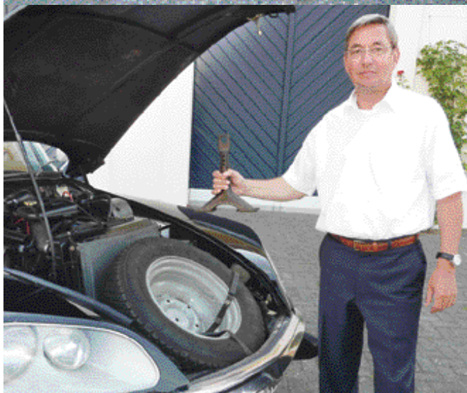
Statt Wagenheber wurde eine Stütze mit einsetzbarem Stift mitgeliefert. Zum Radwechsel wird die Hydraulik benutzt des Wagens genutzt.
